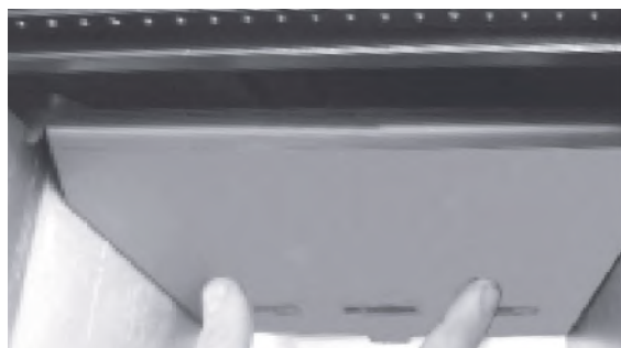
Fig. 14: soulever la plaque coupe-flamme
