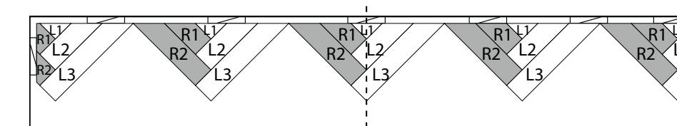
Lijn de eerste startset uit met een krijtlijn die de middellijn van de kamer weergeeft (om de planken uit te lijnen, let erop dat de lijn door de top van het patroon loopt). Hou steeds 8 mm afstand van de muur.
