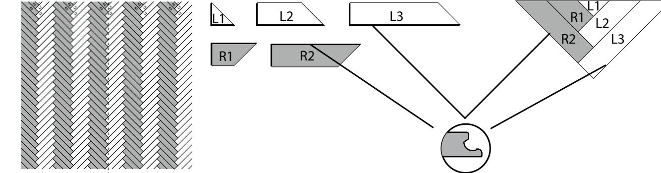
Snij de startstukken op maat zoals hieraast aangegeven (L1, L2, L3, R1, R2) die nodig zijn voor de startset. Je kan slechts 1 stuk snijden uit 1 plank, dit betekent dat je 5 planken nodig hebt voor het snijden van de 5 stukken.
