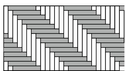
À l'aide d'un crayon, d'un fil et d'une règle, tracer une ligne à 45° qui sera utilisée pour aligner le dessin conformément à l'image. Vous pouvez ensuite commencer à placer vos écarteurs en décalé le long du mur en ménageant un espace de dilatation de 8 mm par rapport au mur.
