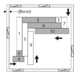
**CONSEILS POUR LA COUPE:** Pour installer la 3e (L), la 4e (R) et n'importe quelle autre lame dont le côté court se trouvera contre le mur, mesurer la longueur de la lame afin de l'adapter et de la couper en conséquence. S'assurer d'utiliser le bon côté de la lame (voir les images ci-dessous).
