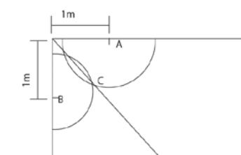
Start in de linkerhoek tegenover de deur. Gebruik eerst een L plank en leg de tandzijde naar de muur. Neem dan een 2<sup>o</sup> plank (R gemaakte) en plaats die loodrecht ten opzichte van de eerste (zie tips ivm het klikken onderaan). Voor de 3<sup>o</sup> en 4<sup>o</sup> plank, zie de snijtips hieronder. Installeer zo verder.
