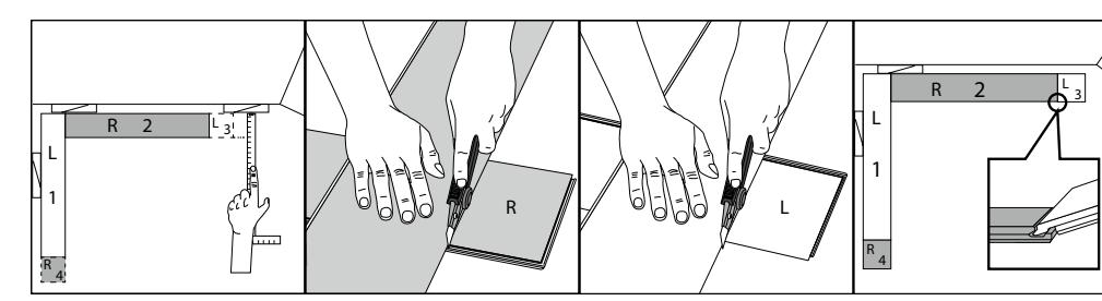
Ce schéma de pose est donné à titre d'exemple, cela dépend de la forme de la pièce. Il est important de toujours commencer par les lames placées contre les murs.
