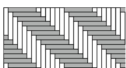
Teken met behulp van een potlood, touw en meetlat een lijn in een hoek van 45° zoals op de tekening. Die lijn zal gebruikt worden om het patroon uit te lijnen. Plaats daarna de afstandsblokjes langs de muur en hou 8 mm afstand.
