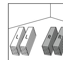
Door de L en R planken in aparte stapels te leggen zal het gemakkelijker zijn om de juiste plank te nemen als de L of R markering afgesneden is.
