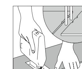
Openingen voor buizen: Boor het gat voor een buis altijd 16 mm groter dan de diameter van de buis. Zaag het deel af zoals te zien is op de tekening, en leg de tegel op zijn plaats. Daarna leg je het uitgezaagde stuk op zijn plaats.
