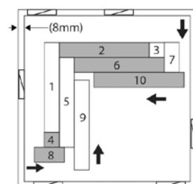
**SNIJTIPS:** Om de 3<sup>o</sup> (L), de 4<sup>o</sup> (R) en de andere planken die met de korte zijde tegen de muur komen te installeren, moet de lengte van de plank en snij vervolgens. Let erop om de correcte zijde van de plank te gebruiken (zie tekeningen hiernaast).
