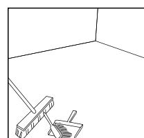
De ondervloer moet vlak, droog en schoon zijn. Eventuele tapjeklemmen of lijmresten moeten verwijderd worden en de vloer moet schoon zijn voor een goede installatie.
