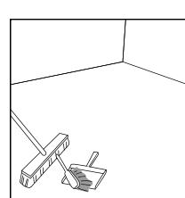
Le sous-plancher doit être plan, sec et propre. Les agrafes ou les résidus de colle doivent être ôtées et le sol doit être propre pour assurer une pose correcte.
