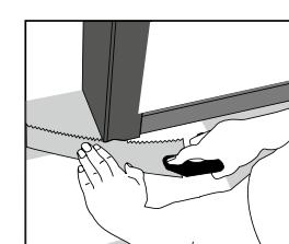
Deurlijsten en plinten: Leg een plank met de onderkant naar boven tegen de deurlijst. Zaag de deurlijst uit zoals in de afbeelding. Leg daarna de tegel onder de afgestaarde deurlijst.
