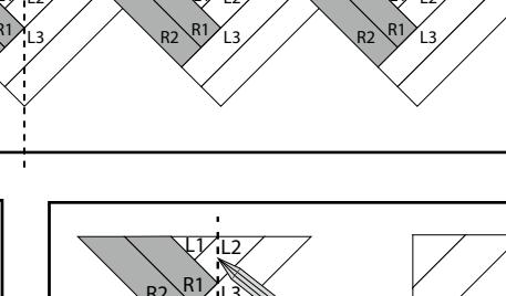
Lijn de eerste startset uit met de middellijn (om de planken uit te lijnen, zorg ervoor dat de lijn door de top van het patroon gaat). Respecteer steeds een uitzetvoeg van 8 mm.
