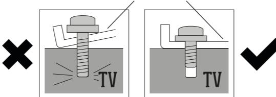
Des boulons et rondelles standards sont fournis avec ce produit. En fonction du modèle de téléviseur, vous aurez peut-être besoin de boulons spéciaux.
