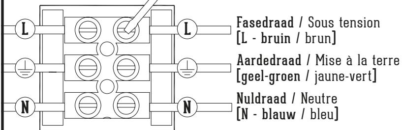
7] Verbind de juiste draden van de ontvanger van de afstandsbediening conform bovenstaande stroomschema. Wees er zeker van dat alle draden goed bevestigd zijn binnen het kroonsteentje.
