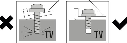
Des boulons et rondelles standards sont fournis avec ce produit. En fonction du modèle de téléviseur, vous aurez peut-être besoin de boulons spéciaux.
