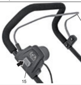
Mise en marche: enfoncez le bouton de sécurité (15) en serrant simultanément la poignée marche/arrêt (7). Arrêt: Relâcher la poignée marche/arrêt (7).
