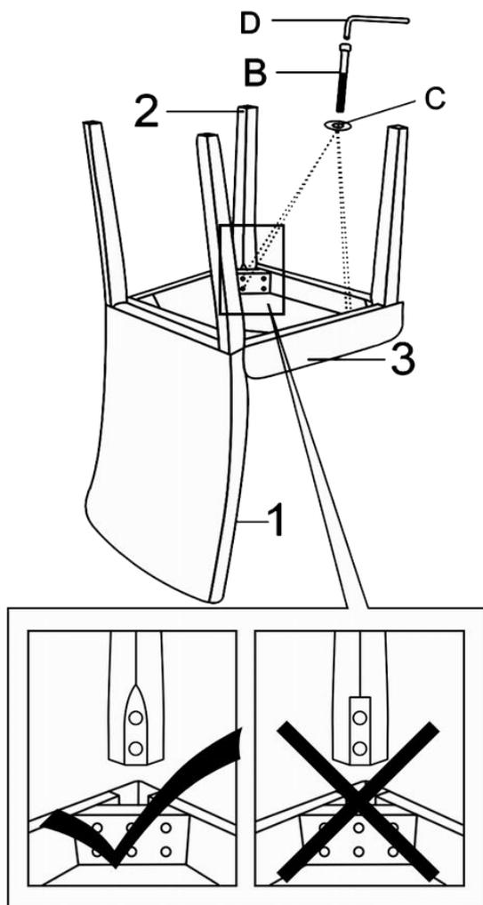
Plaats de voorpoten (2) in de uitsparing van de zitting (3). Zorg ervoor dat de voorpoten (2) in dezelfde hoek staan en draai dan pas de bouten (B) met de sluitringen (C) losjes vast.
