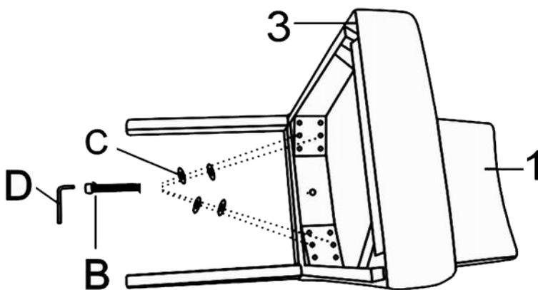
Draai daarna de bouten (B) met de sluitringen (C) in de aangegeven posities.
