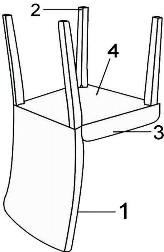
Draai de stoel weer om en plaats de stoffen onderzijde van de zitting op de onderzijde van de stoel. Dit kan vastgemaakt worden met behulp van klittenband.
