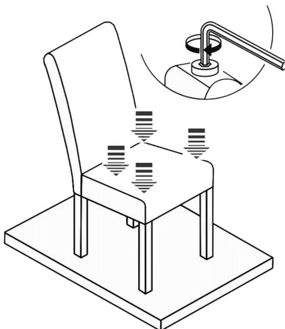
Plaats de stoel op een vlakke ondergrond. Zorg ervoor dat de stoelpoten waterpas staan en draai dan alle bouten handvast.
