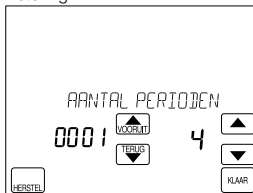
Figuur 12: Eerste installateursinstelling
