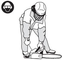
Enfoncer la commande du starter dès que le moteur s'allume et répéter les lancements jusqu'au démarrage. Quand le moteur démarre, accélérer rapidement à fond, ce qui supprime en même temps le ralenti accéléré. Le frein de chaîne étant encore activé, le régime du moteur doit être mis sur le ralenti le plus vite possible en déconnectant rapidement la gâchette d'accélération.
