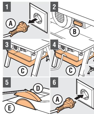
**Attention !** De l'eau est nécessaire pour le refroidissement de la lame de la scie circulaire, pour éviter le dégagement de poussière et une usure excessive. Ne pas oublier de remplir le bac à eau !
